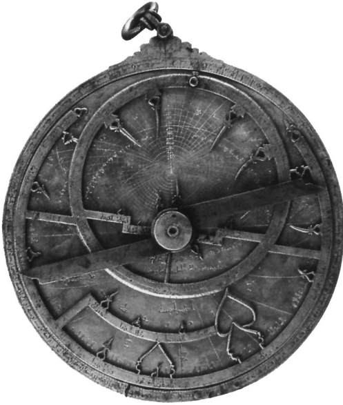
Figura 4. Astrolabio árabe, utilizado por los navegantes hasta la edad moderna. Tomado de El Islam, la Meca y la gran expansión , Madrid, Ediciones Rueda, 2002, p. 142.
