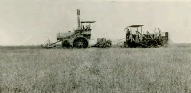
Tractora que arrastra una maquina cosechadora que corta, trilla, empaca el grano y amontona la paja de diez hectáreas diarias.
