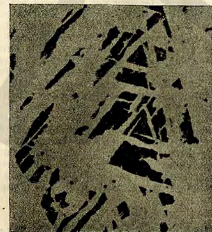
Abb. 8. Feingefüge von ungeglühtem Stahlguß.
