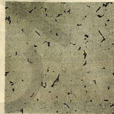
Abb. 1. Flußeisen mit weniger als 0,1% Kohlenstoff, gegläht. 100 ×
