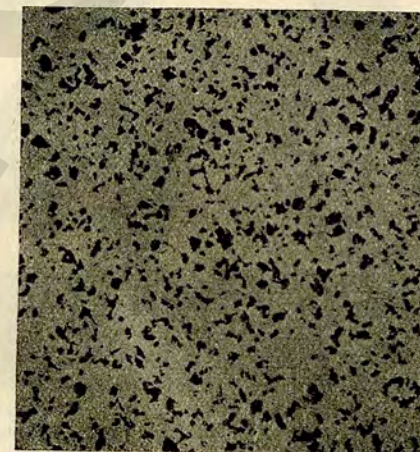
Abb. 9. Feingefüge von geglähtem Stahlguß.
