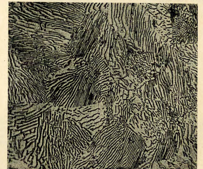
Abb. 3. Stahl mit 0,9% Kohlenstoff, gegläht; sein Gefüge besteht nur aus Perlit. 600 ×
