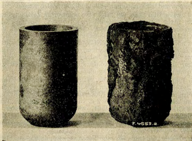
Abb. 27. Glühtöpfe aus „Alit“ (links) und Flußeisen (rechts), die 190 Stunden lang im Temperofen bei 950° C erhitzt worden waren.
