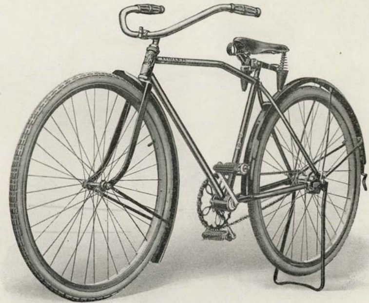
Modelo 74 Boy Scout con 'coasterbrake' (freno automático)
