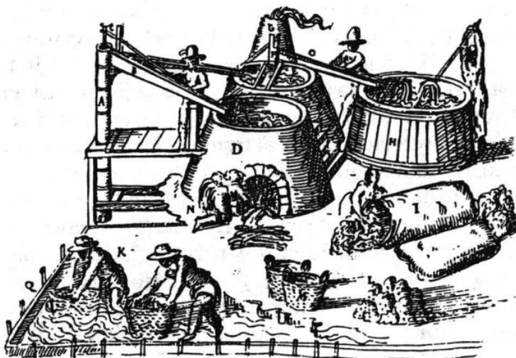
A= bomba para extraer el agua; B= canal; C= palanca o “lámina” de la bomba; D-E= calderas; F= la bomba de la caldera; H-O= canal y tina “donde se hecha agua para escaldar la lana”; I= sacas de lana sucia; K= oficiales encargados de lavar la lana; L= lana por lavar; N= oficial encargado de dar fuego a las calderas; P= oficiales encargados de escaldar la lana; Q= “ampara” o cerca que evita que el agua arrastre la lana.
