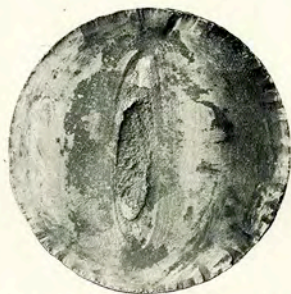
Abbild. 1. Bruch einer Achse eines Straßenbahn-Motorwagens.
