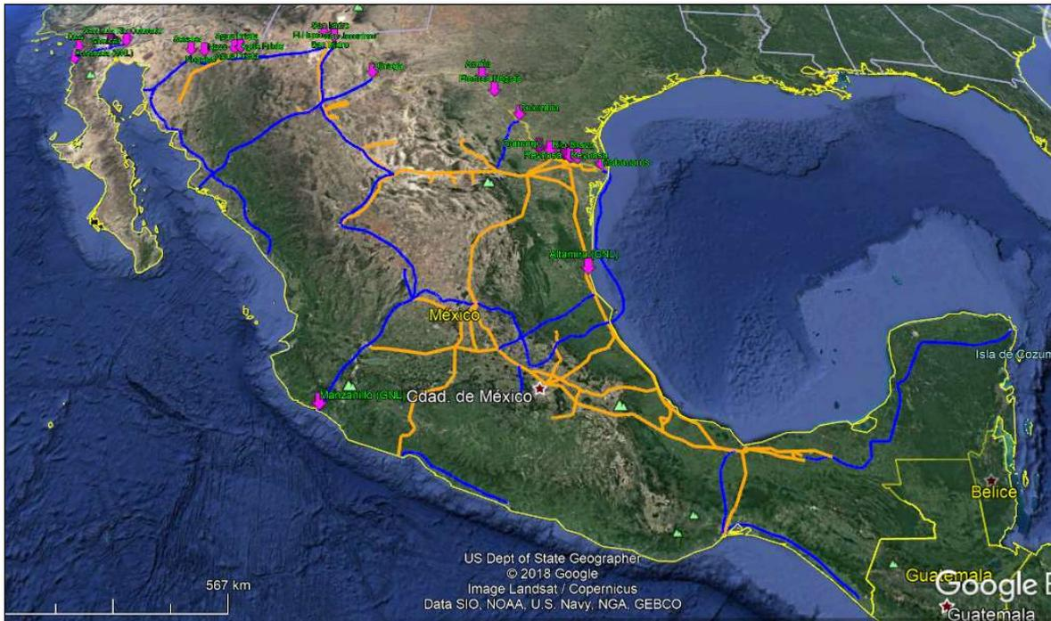
*Figura 7: Gasoductos principales, en naranja los ductos asociados a Sistrangas y en azul los ductos no asociados, en rosa puntos de entrada de gas al sistema. Fuente: Elaboración con información de base de datos Infraestructura de gas natural (Centro Nacional de Información de Hidrocarburos, n.d.).*
