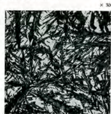
Abbildung 36. Austenit mit eingelagertem Martenit.
