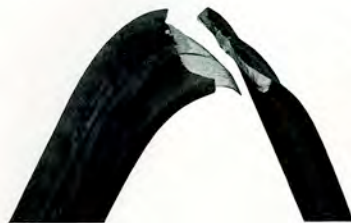
Abbild. 80. Bruchbild eines gehärteten Tragfederblattes.
