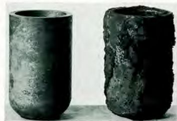
Abbildung 26. Alit- und Eisentiegel nach 190tündigem Glühen in einem Temperofen bis 950°.
