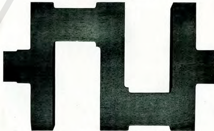
Abbild. 82. Faerverlauf einer aus dem Vollen herausgearbeiteten Kurbelwelle.
