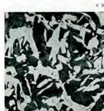
Abbild. 45. Gußstruktur (Grobe Kornstruktur).
