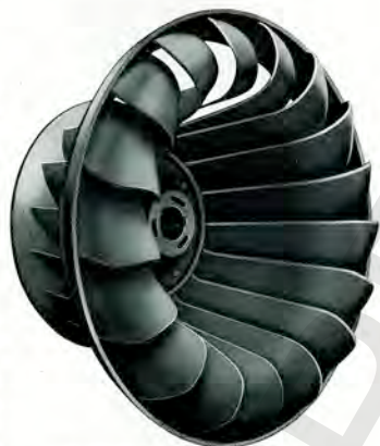
Abbild. 76. Laufwerk einer Francisturbine.
